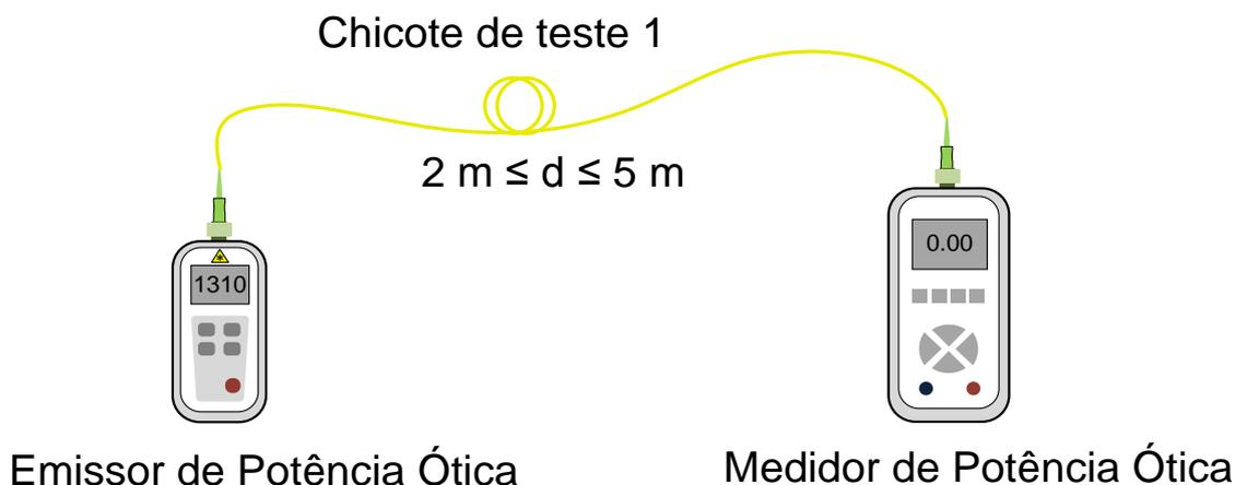
6.18 - Calibração dos equipamentos de ensaio ótico
