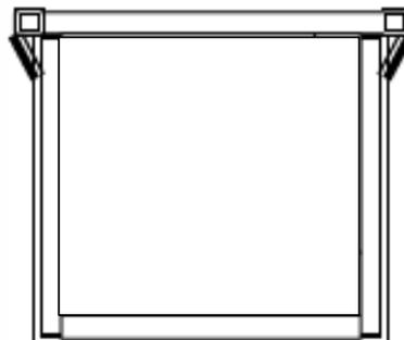
3.17 - Câmara de visita do tipo CVR, pré-fabricada
