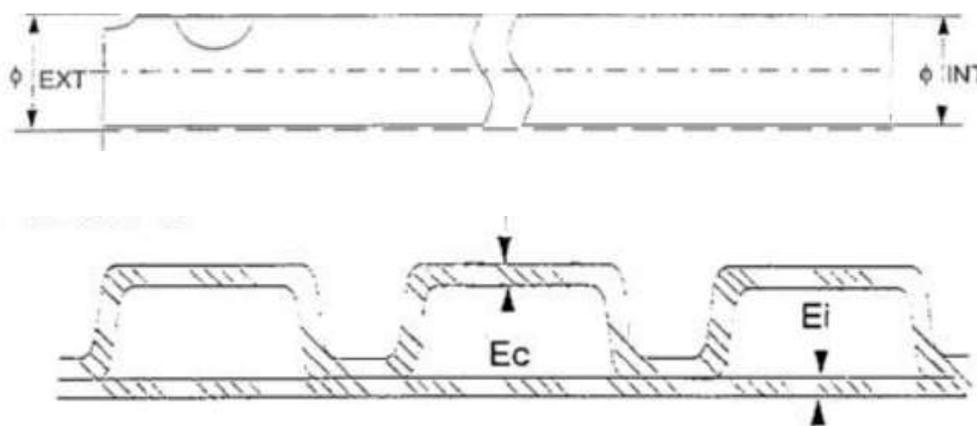
3.1 - Corte longitudinal de um tubo corrugado
