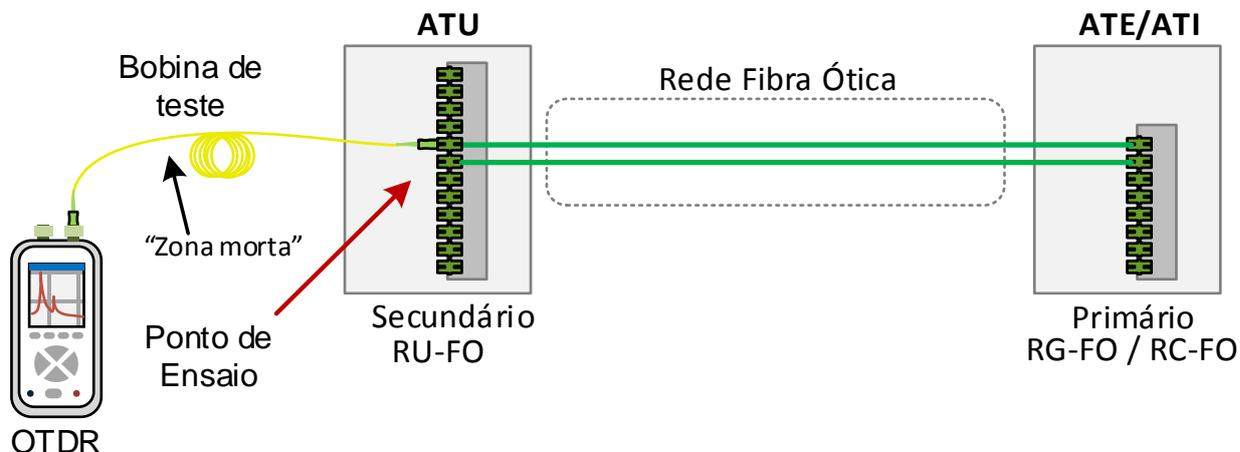
6.20 - Ensaio para determinação do atraso na ligação
