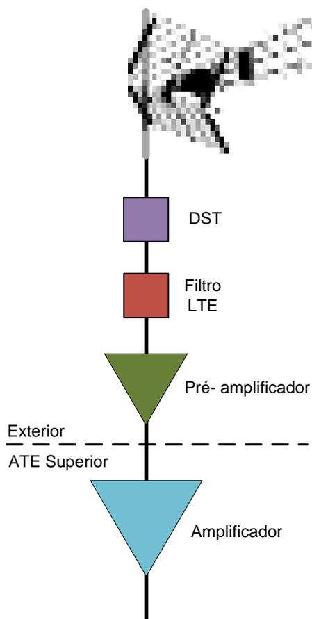
5.11 - Exemplo de esquema de instalação das antenas
