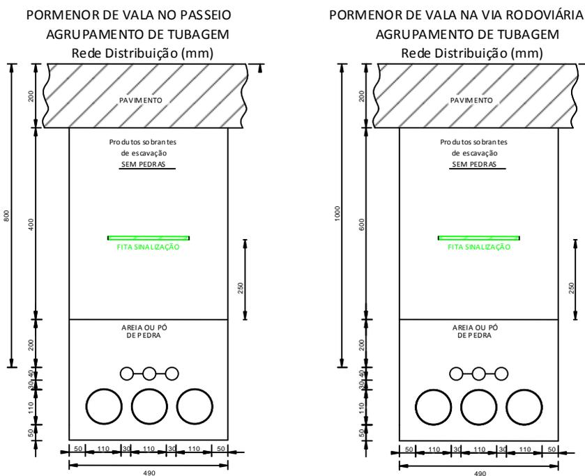
5.9 - Desenho esquemático de corte de uma vala técnica da rede de distribuição
